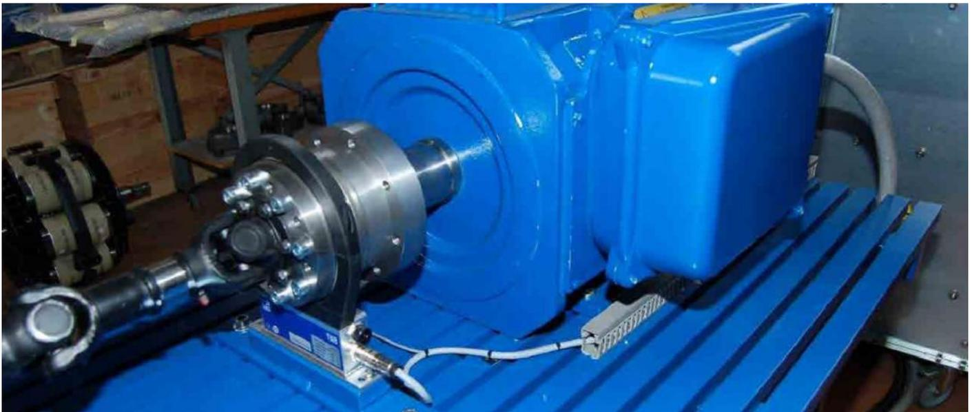
Chargé de développer un banc d'essais de moteurs de voitures électriques, Dynosens avait besoin d'une interface pour raccorder son couplemètre T40B sur le bus de terrain EtherCAT. Le TIM-EC, que HBM était en train d'introduire sur le marché, s'est révélé immédiatement opérationnel...
