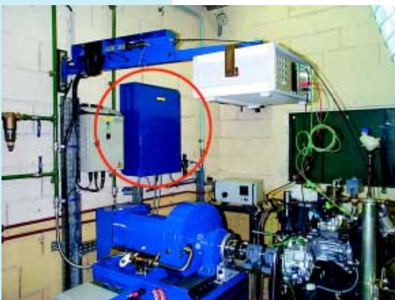
DMC 202 avec son capot de protection installé dans une cellule d'essai
